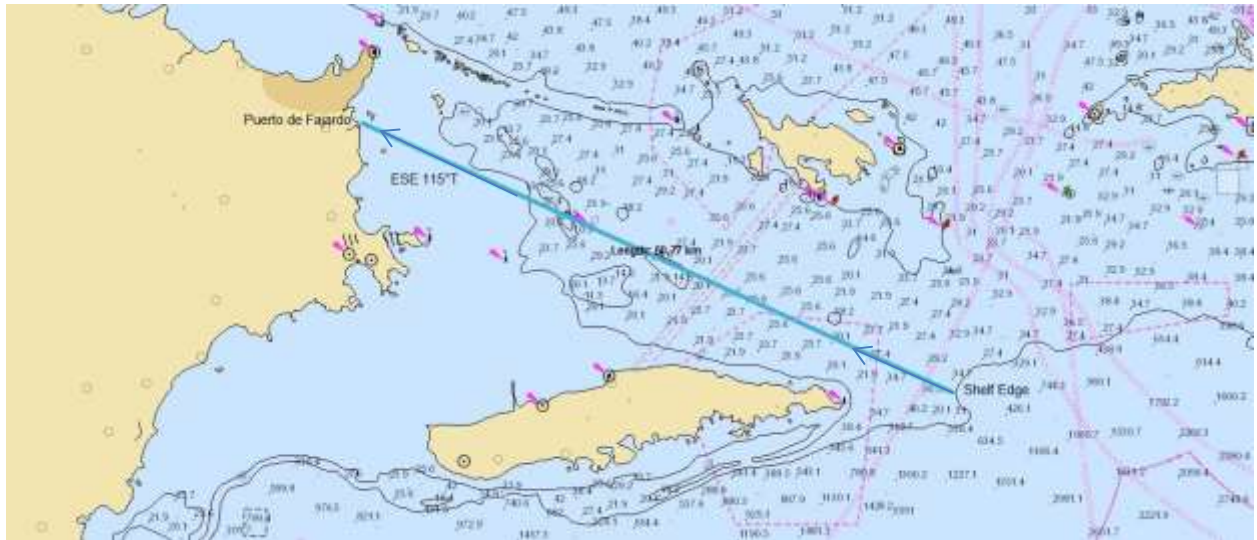
Figura 2. Trayecto del pulso de presión atmosférica desde el veril de la plataforma hasta llegar al Puerto de Fajardo. Abarca una distancia de 50.8 km con una dirección de 115° T relativo al Puerto de Fajardo.
